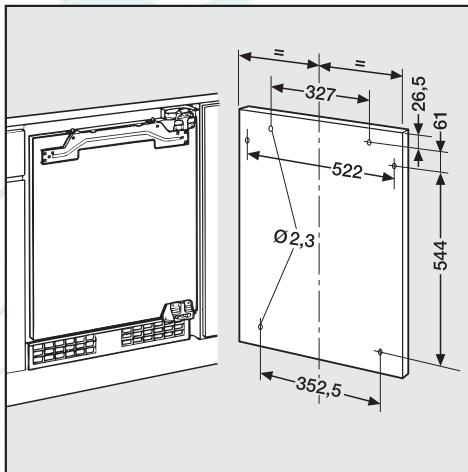
Рисунок для просверливания отверстий
